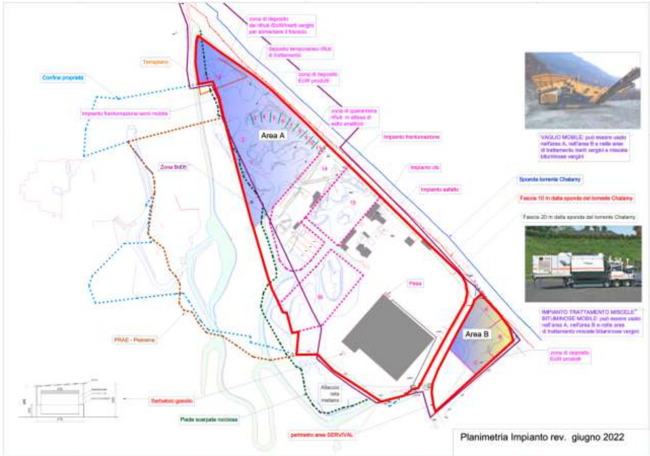
Figura 4 Planimetria Impianto con aree trattamento rifiuti
