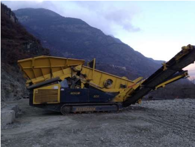
7Figura 7 - Impianto mobile vagliatura Keestrack-K4 Novum
